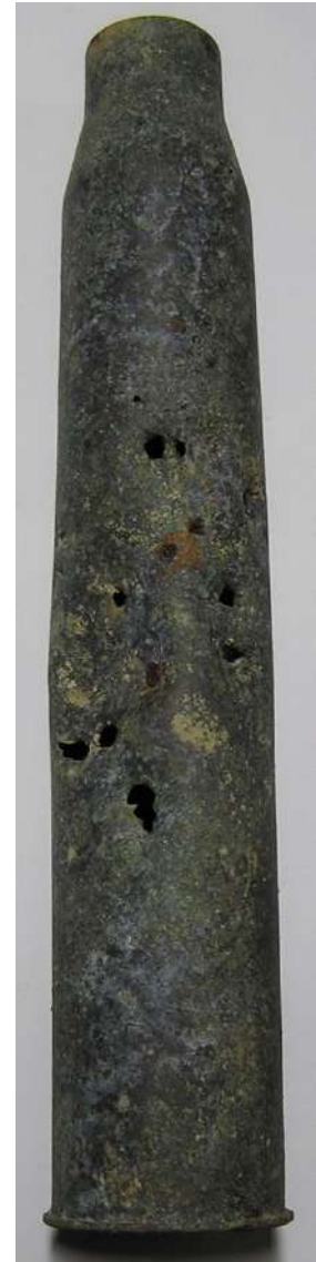
Egy hatalmas erejű robbanás nyomait viselő 57 mm-es szovjet ZISZ-2 páncéltörő ágyú maradványai és a löveg egyik sérült hüvelye, melyek Lengyeltóti közelében került elő a szántásból.
